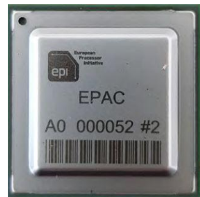
Πρώτο δοκιμαστικό chip του Ευρωπαϊκού Επεξεργαστή RISC-V που έδωσε τα πρώτα σημάδια ζωής του στην Κρήτη το Σεπτέμβριο 2021
